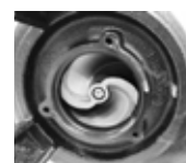
Wirnik otwarty z krawędziami tnącymi
